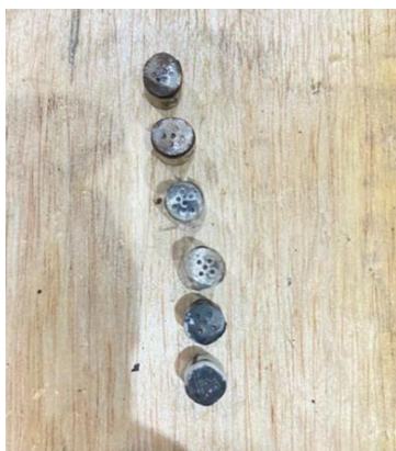
Gambar 2. Hasil Deburring Spesimen Uji Baja Karbon Rendah
